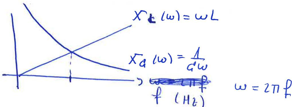
$$X_C(\omega) = X_L(\omega) \Leftrightarrow \omega L = \frac{1}{\omega C};$$
